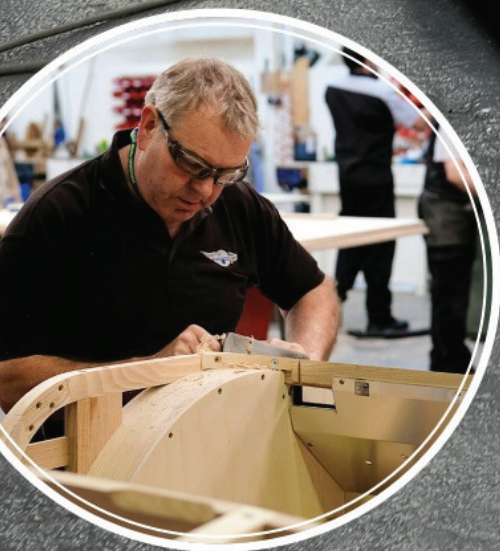
◀ Saarnipuista ohjaamon apurunkoa viimeistellään perinteisin puutyökaluin. Käsihöylä ei yleensä kuulu autotehtaiden vakiovarustukseen.
