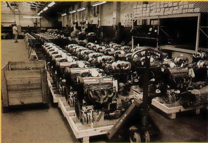
Morganeissa käytetään nykyään Fordin ja Roverin moottoreita. Tässä on rivistö Fordin 1,8-litraisia nelikoita, jotka kulkeutuvat vähitellen 4/4-mallien konehuoneisiin. Plus 4:n moottori on Roverin kaksilitrainen nelonen ja Plus 8:n pata saman valmistajan veeaksi. Tehot 121/134/185 hv.
