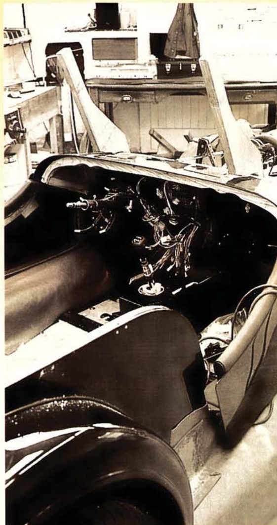
Ennen verhoilua ja kojelaudan kiinnittämistä johtoniput on saatava järjestykseen. Morgankaan ei kulje ilman sähköä!
