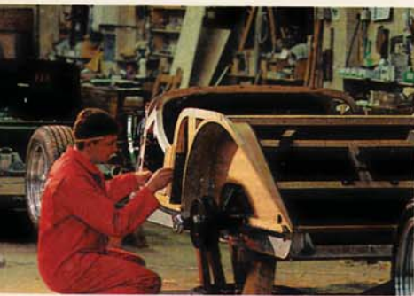
Gut Holz: 94 Teile für einen Holzrahmen
