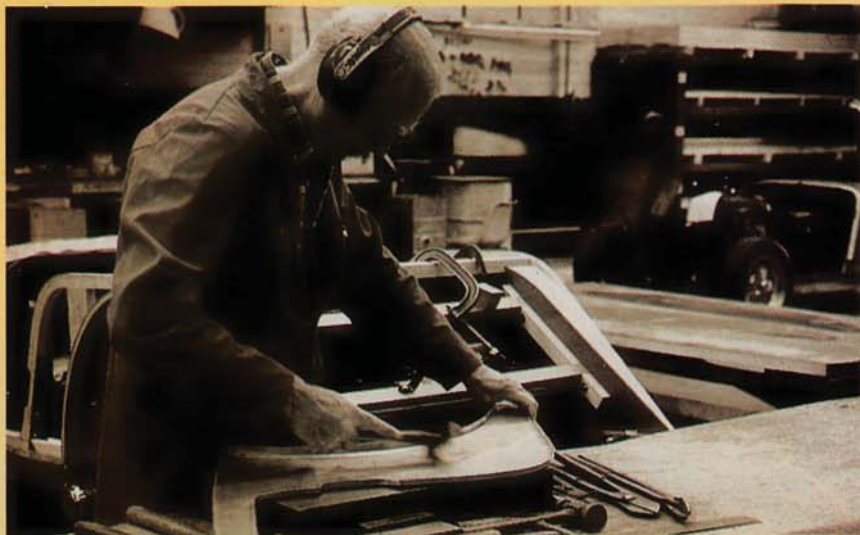
Morgan on käsityötalon mestarinäyte. Tässä naputellaan kaarevaa korin palaa oikeaan muotoonsa. Kilkatus peltityöhallissa on niin helvetillinen, että ilman kuulosuojaimia siellä viihtyy vain hetken.
