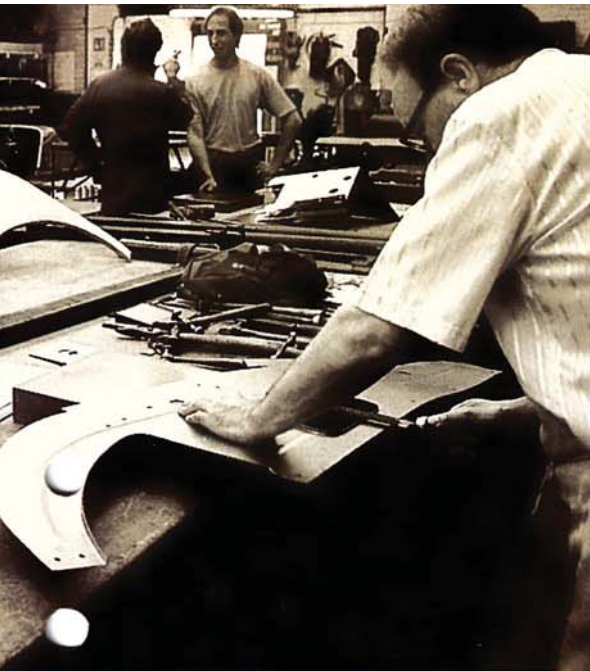
Useimmat tilaavat Morganiinsa alumiinikorin. Olli koppa sitten terästä tai alumiinia, naputtelua ja mittausta riittää ennen kuin kaarevat muodot ovat kohdallaan.
