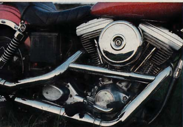
Moment mal: 108 Millimeter Hub für 97 Newtonmeter
